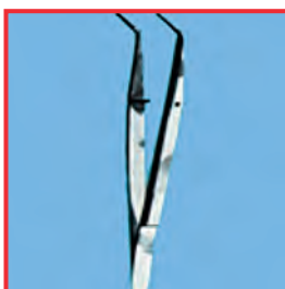
Částečné naleptání a usazeniny leptavého hemostatického prostředku na povrchu nástroje. Příčina: moc dlouhá doba kontaktu
