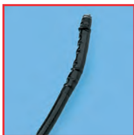
Nabobtnání na distálním konci fibroskopu
