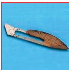
Narušení materiálu čepele vlivem vlhkosti. Příčina: složení materiálu – jednorázový výrobek z běžné oceli.
