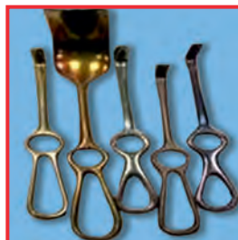
Typické zbarvení v komoře myčky a na povrchu nástrojů způsobené čisticími prostředky s obsahem silikátů nebo nadměrným obsahem kyseliny křemičité ve vodě
