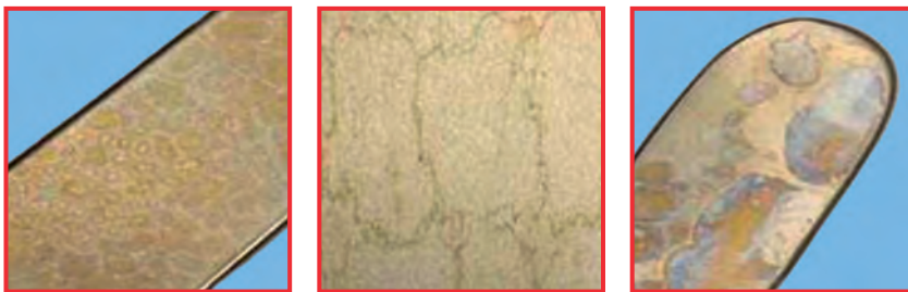
Typické zbarvení silikáty na povrchu nástroje po parní sterilizaci, způsobené nadměrným obsahem kyseliny křemičité v úplně demineralizované vodě.
