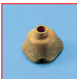
Trhlinky na dýchací masce způsobené stárnutím
