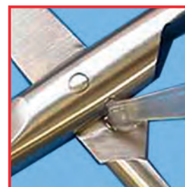
Zamezení: cílená konzervace nástrojovým olejem
