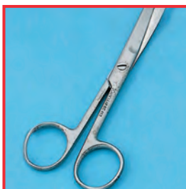
Nůžky s důlkovou korozí
