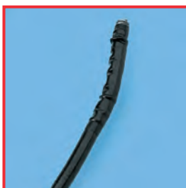
Nabobtnání na zaváděcí hadici při použití nesprávné konzervační látky
