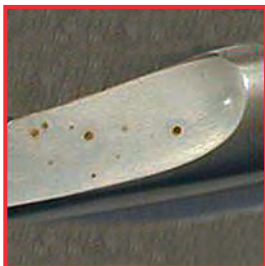
Chloridem způsobená důlková koroze na nástroji
