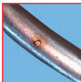
Důlková koroze na pinzetě. Příčina: Pod přestárý pásek barevného označení se dostávají škodlivé látky obsahující chloridy.
