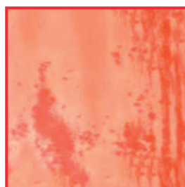
Narušení materiálu na bezbarvě/barevně eloxovaném hliníkovém povrchu kontejneru. Příčina: nadměrně zásaditý mycí roztok
