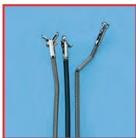
Násilně poškozené bioptické kleště
