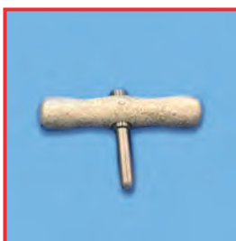
Naleptání pájených spojů. U tvrdokovových nůžek, tvrdokovových držáků pinzet a jehelců. Příčina: narušení kyselostí při předávkování neutralizačních prostředků nebo použití základních čisticích prostředků.
