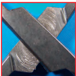
Zadírání kovu při nedostatku konzervačního prostředku
