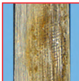
Kostní nůžky, na kluzné ploše posuvné části se projevuje třecí koroze.
