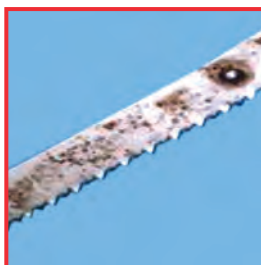
Narušení materiálu částečně porušené chromové vrstvy. Příčina: Vlhkost způsobuje rezavění nechráněného základního materiálu z běžné oceli.
