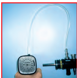
Ruční zkouška těsnosti flexibilního endoskopu
