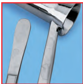
Skvrny způsobené vysokým obsahem solí v oplachovací vodě
