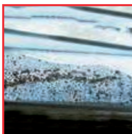
Částečné naleptání a usazeniny leptavého hemostatického prostředku na povrchu nástroje. Příčina: moc dlouhá doba kontaktu
