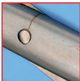
Napěťová trhlina u závitů na nůžkách
