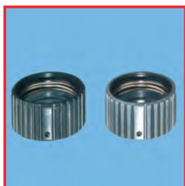
Na obrázku vpravo: Narušení černého eloxovaného hliníku změkčenou vodou
