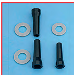
Vpravo: těsnění nabobtnalá v důsledku nedbalosti při nanášení nástrojového oleje Vlevo: nová těsnění
