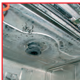
Komora myčky se silným vápen-covým povlakem
