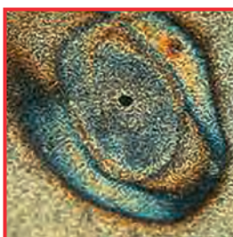
Ukázka důlkové koroze
