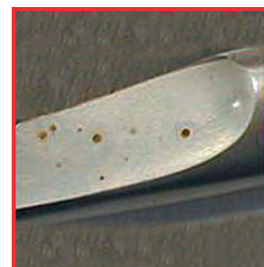
Ukázka důlkové koroze
